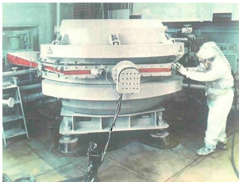
Уникальный электромагнитный масс-сепаратор С-2 для получения высокообогащенных радиоактивных изотопов (ВНИИЭФ)
