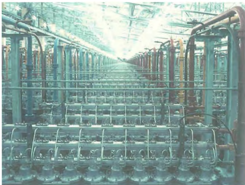
Один из центрифужных модулей обогатительного производства
